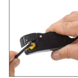
Wprowadzanie kabla koncentrycznego.
