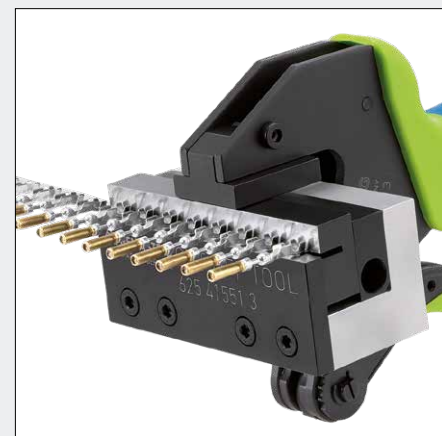
Narzędzie do oddzielania pojedynczych złączy z taśmy.
