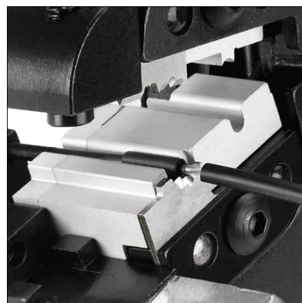
ściągnięcie izolacji kabli oraz...
