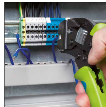
Nr art. 610 088 3 - możliwość ładowania od czola do maks. 16 mm 2 – korzystne w przypadku krótkich końców przewodów
