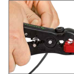
Cięcie kabla koncentrycznego.
