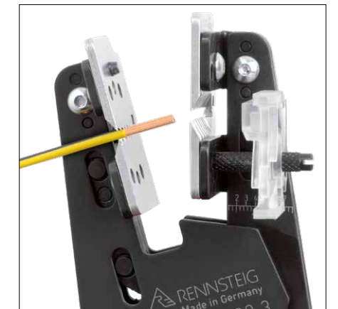
Automatyczne usunięcie izolacji
