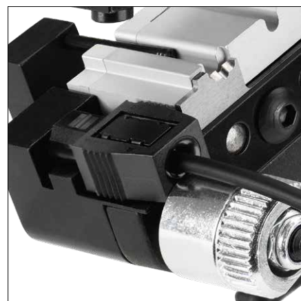
zagniatanie złącza z przygotowanym kablem w narzędziu.
