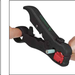
Ściąganie izolacji z okrągłego kabla przesyłu danych.
